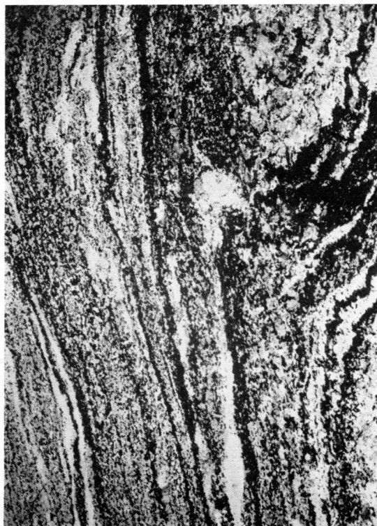
Abb. 4 Wechsellagerung der Strukturtypen A 1, A 2 und B 2 ergibt eine feine Bänderung (Hämatit schwarz, Quarz hell). Fianell, Hämatitquarzit. Dünnschliff 15fach vergrößert
