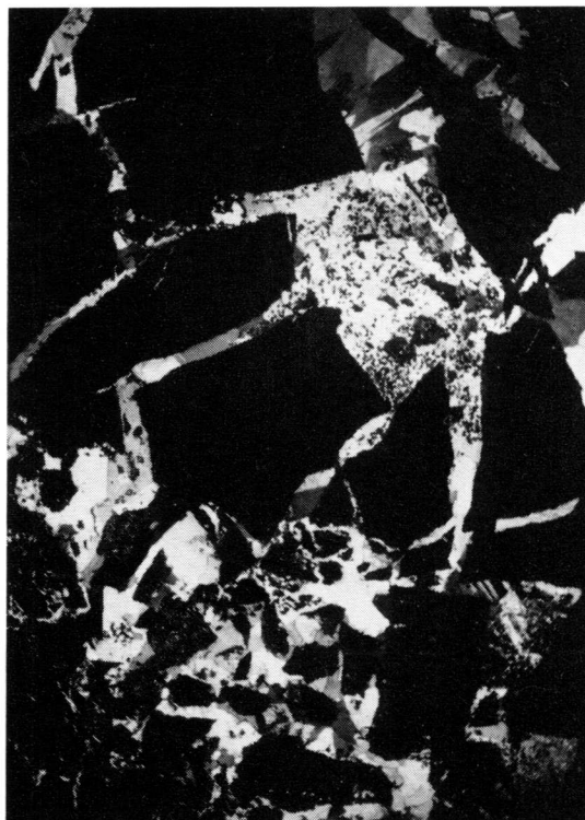
Abb. 2 Strukturtyp C 1. Scharfkantig begrenzte Bruchstücke von dichtem Aegirinaugit (schwarz) durch Quarz, Albit und Rhodonit (hell) zusammengekittet. Silikatische Eisen-Manganzone Fianell. Dünnschliff 15fach vergrößert. X Nicols
