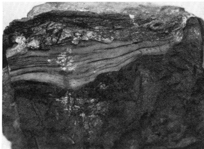
Fig. 11. Abfolge von Kristallin (oben), gebändertem Triasmarmor (Mitte, hell) und massiger Erzzone (unten). Handstück Starlera, halbe nat. Größe
