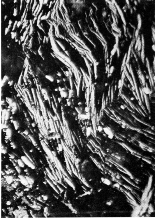
Abb. 1 Eisenhydroxyd (Nadeleisenerz). Lagiger Hämatiterzhorizont Starlera. Anschliff etwa 350fach vergrößert. Ölimmersion
